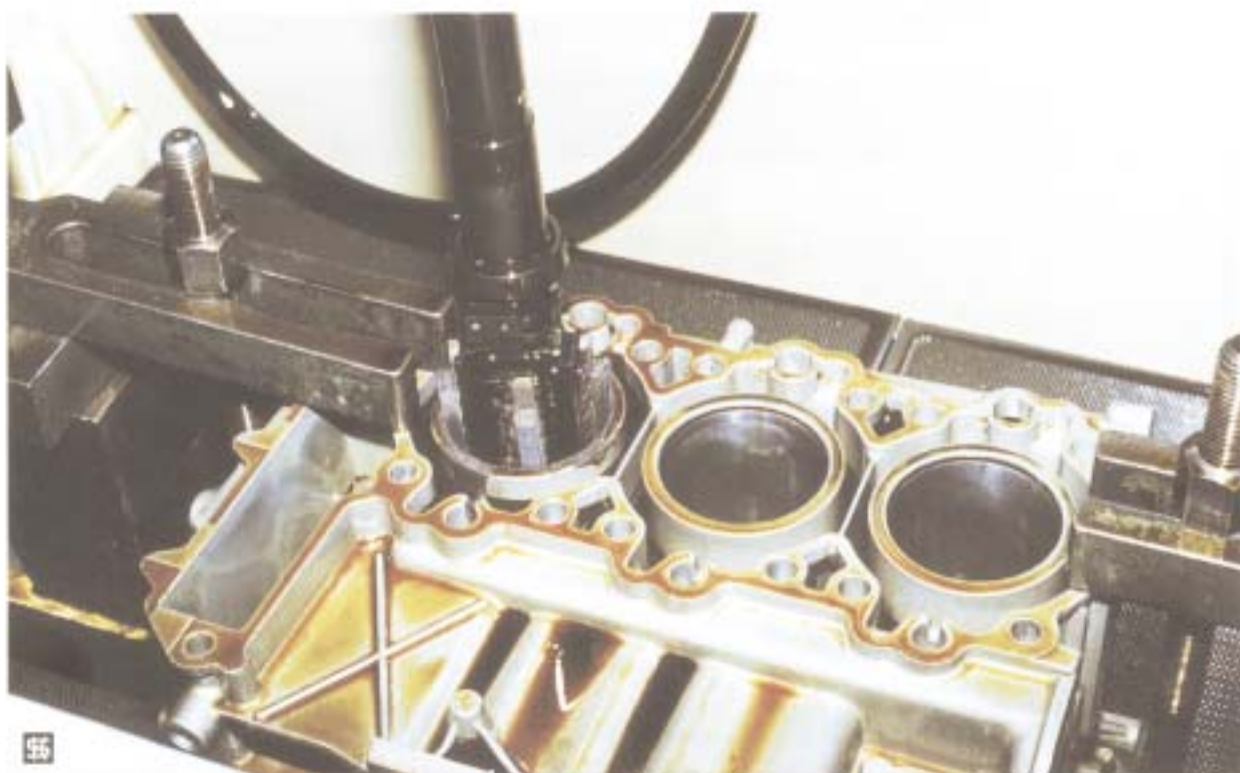
Obr. 11 Opravování lokasilového motorového bloku Motor: Porsche Boxster
