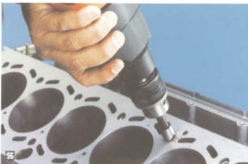
Obr. 14 Čepovou frézkou se jádrový otvor vyhloubí (hloubka 2,5 mm).
