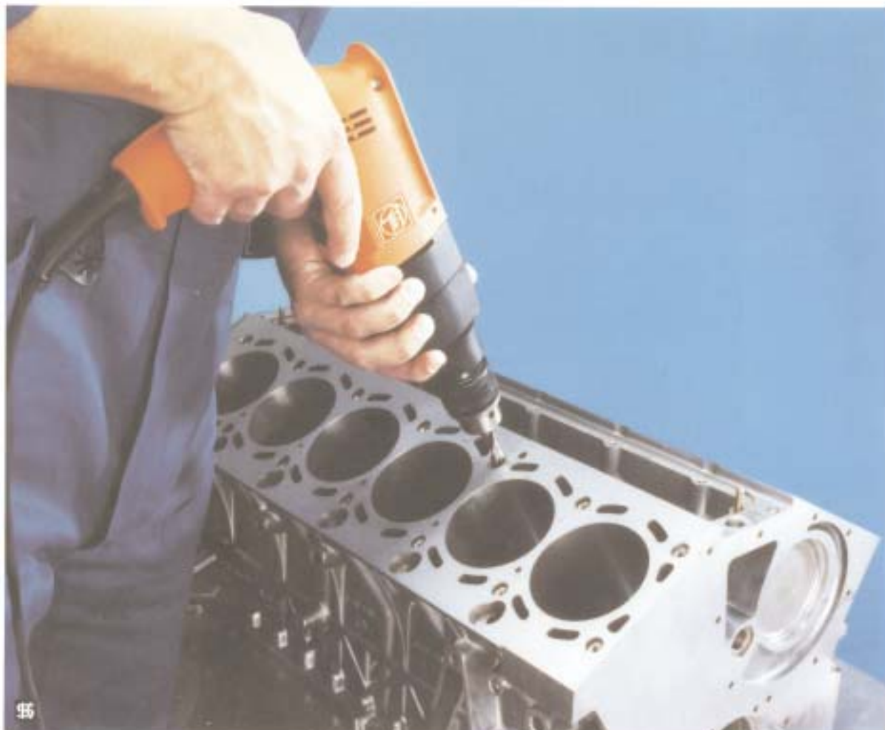
Obr. 13 Vrtáčkou vyvrtat jádrový otvor nebo převrtat starý závit.
