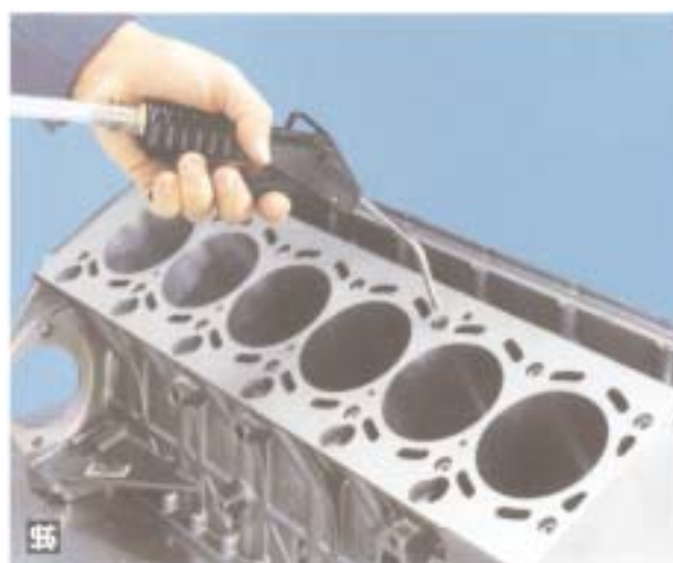
Obr. 16 Důležitě: Vytoukat třísky a olej.
