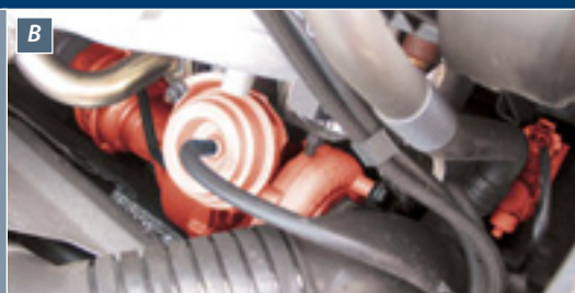
B Electropneumatický tlakový snímač (EPW) a turbodmychadlo v Audi A4 TDI (zvýrazněn).
